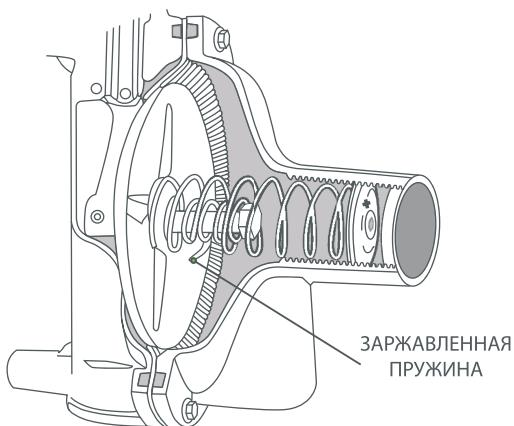
Внеплановый контроль может проводиться с осмотром наружной поверхности потенциально опасной ситуации (образования взрывоопасной концентрации). и полости под прижимной гайкой после снятия колпачка. Это может помочь заблаговременно обнаружить коррозию. Регулятор должен осматриваться более детально квалифицированным и обученным специалистом.
